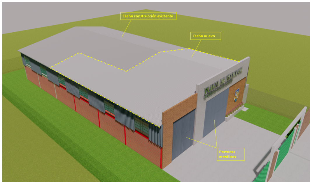
Figura 28. Detalles del techo y cerramientos.
